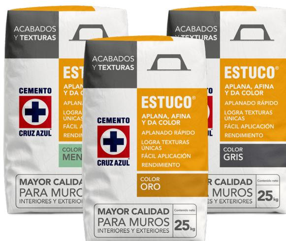
El **ESTUCO CRUZ AZUL®** es un recubrimiento en polvo compuesto por cemento Portland Cruz Azul® blanco, cargas minerales, pigmentos y aditivos químicos, fácil de trabajar y de gran adherencia. Ideal para dar acabados y texturas finales coloreadas en un solo paso a muros, bardas y fachadas interiores o exteriores proporcionándoles resistencia a la humedad.
